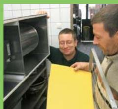
Stäube werden vorgelüftet, die Gerüche, Feinstäube und Schadgase oxidieren anschließend mittels „kalter Verbrennung“ in offenem Normaldruck-Plasma. „Miniblitze“ zersetzen die Geruchsmoleküle dabei auf atomarer Ebene. Nicht verbrannte Verbindungen werden in einem Aktivkohlespeicher gefangen. Endprodukte sind lediglich Sauerstoff, Luftfeuchtigkeit sowie CO<sub>2</sub>: entkeimt und geruchsfrei mit Garantie.
